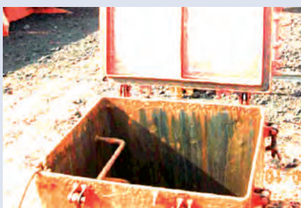
货舱出入口和舱口围缘有明显的进水痕迹。
