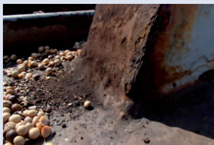
舱口围缘没有打扫干净，货物残留和锈渣清晰可见。舱盖板中心线接缝合模楔子严重磨损。
