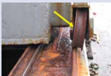
El cojinete de la rueda de la tapa ha fallado – la tapa no cerrará uniformemente.
