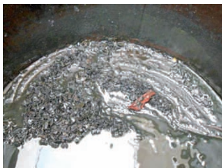
蠟狀沉澱物/污泥出現在液貨艙底部
