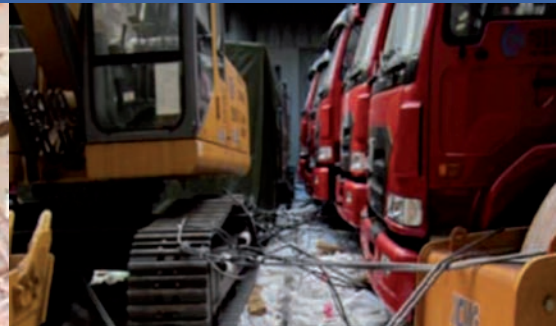
不良的間隔、繫固和網紮方式
