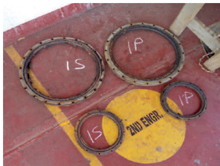
因货物具有腐蚀性导致O型环受损
