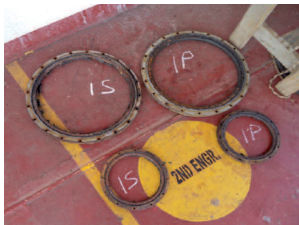
因貨物具有腐蝕性導致O型環受損
