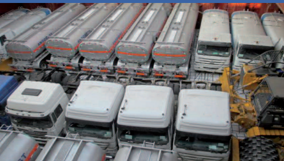
积载在袋装水泥上方的车辆彼此间相隔太近
