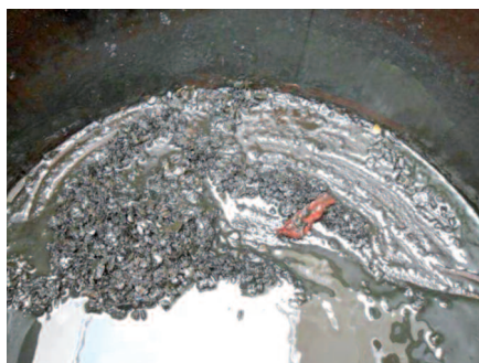
蜡状沉淀物/污泥出现在液货舱底部
