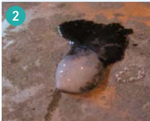
写真2: 硝酸銀溶液は、塩化物に触れると透明から白濁に変化する。
