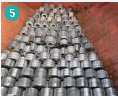
写真5: 最前部と最後部のホールドは、その形状の都合上、積付と固縛がさらに大変になる。
