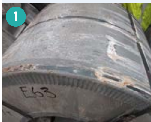
写真1: ホールドに入り込んだ海水で外側のカバーが損傷してしまったCRC。
