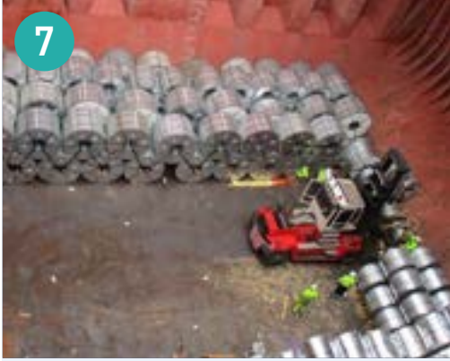
写真7: CRCの荷揚げの様子。コイルの下に敷かれているダンネージと、スチールバンドでコイル同士をきつくまとめているラッシングの様子が分かる。
