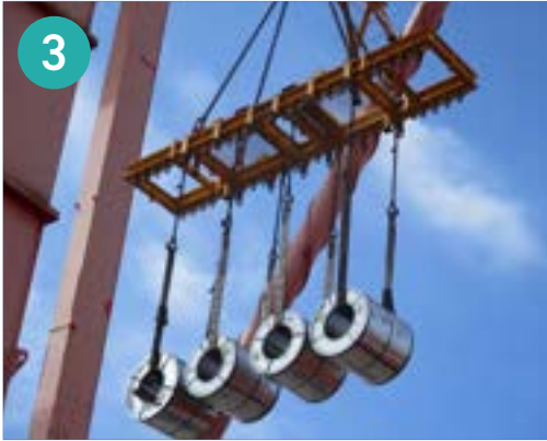
写真3: ウェブスリングで複数のCRCを一度に吊り上げる様子。
