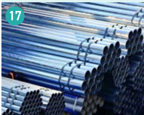
写真17: 鋼管は基本的にバンドル化される。両先端部は特に損傷しやすい。
