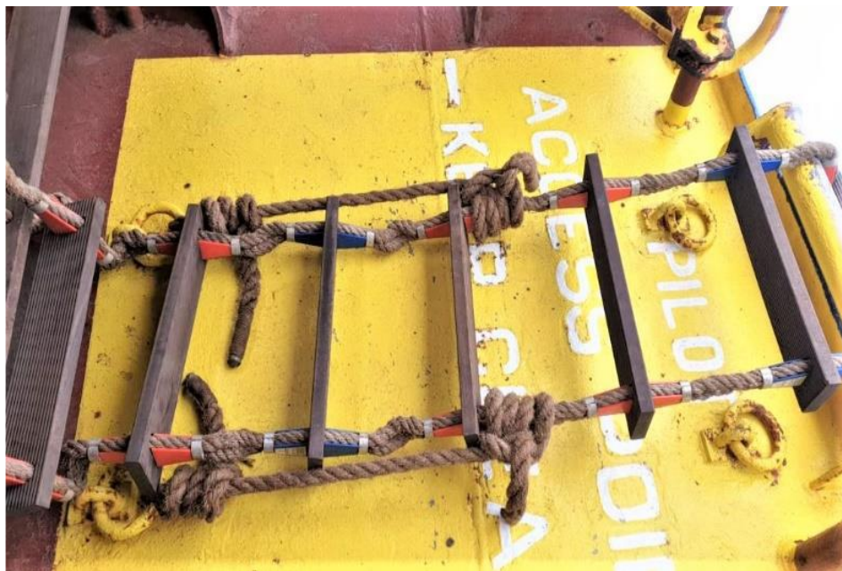
Larawan 7: Ginamit ang “rolling hitch knot” sa pagkabit ng hagdanan ng piloto sa aprubadong matibay na bahagi ng mismong kubyerta (kinopya na may pahintulot mula sa Fremantle Ports)
