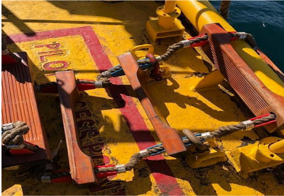
Larawan 4 – Hindi ligtas na pagkabit ng hagdanan ng piloto (kinopya na may pahintulot ng Fremantle Ports)
