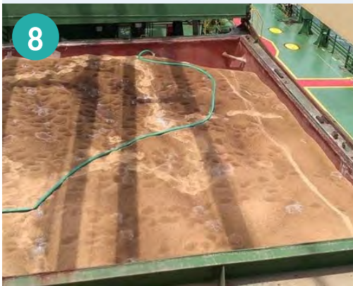
写真8: 燻蒸ガスが爆発した後の貨物の表面と、ガスの拡散に使われたパイプ
