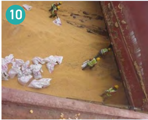
写真10: 損傷した貨物をホールドのサイドコーミングから除去する陸上作業員
