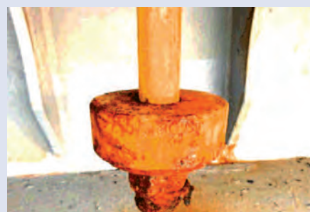
貨艙固定夾扣楔卡住了而且整個被上過油漆。
