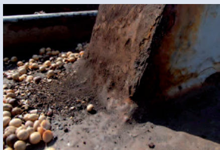
艙口圍緣沒有打掃乾淨，貨物殘留和銹渣清晰可見。艙蓋板中心線接縫合模楔子嚴重磨損。
