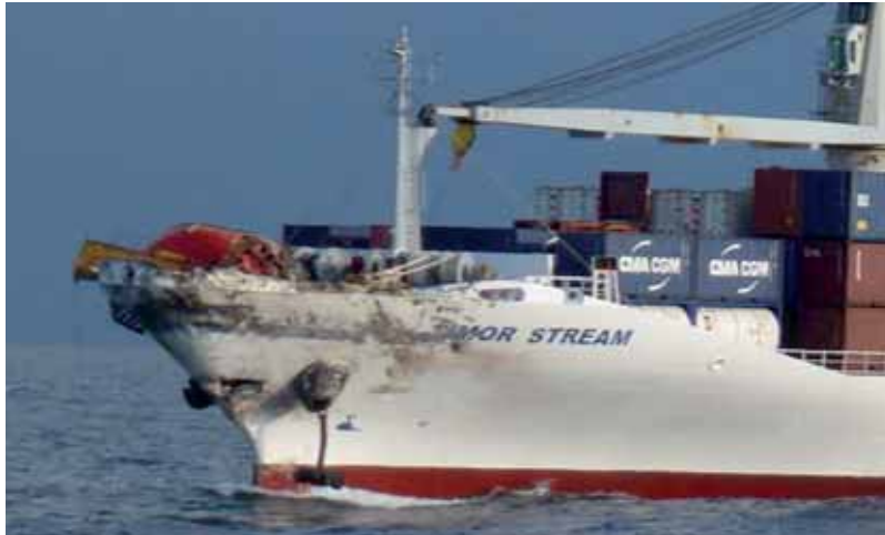
Sección de la amura del TIMOR STREAM – tras la colisión.
