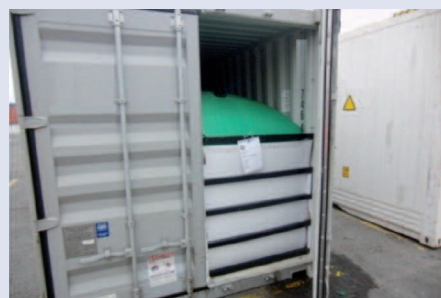
フレキシタンクを装備したコンテナ
