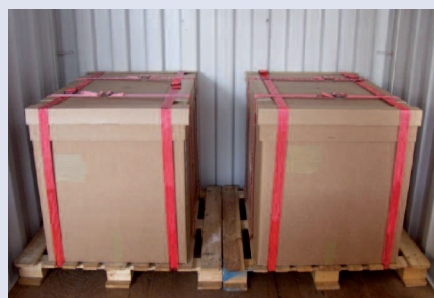
テキスタイルラッシングでパレットにしっかりと固定された貨物
