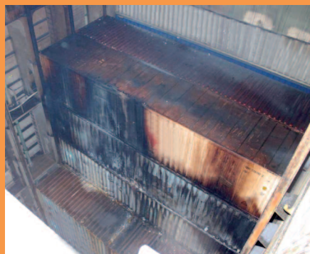
炭火によって起こされたと思われるコンテナへの激しい火災損傷の一例。
