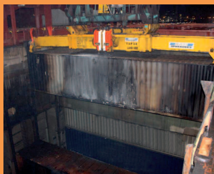
炭火により起こされたコンテナと船倉への熱損傷と煙による染み。
