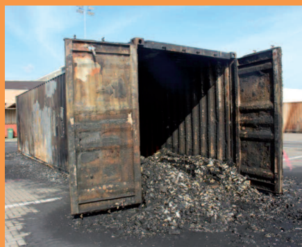
揚げ荷された木炭コンテナ、コンテナの床を突き破って落ちた燃焼物によってどのように木炭が再発火しうるかを示している。
