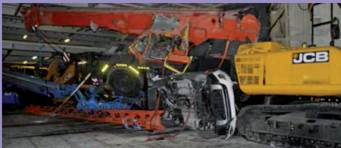
第6甲板 - 右舷側貨物の損傷
