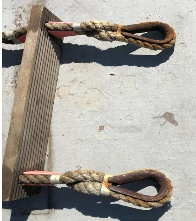
图片 9: 眼环衬套锈蚀示例 (图片使用权获得了弗里曼托尔港务局许可)。
