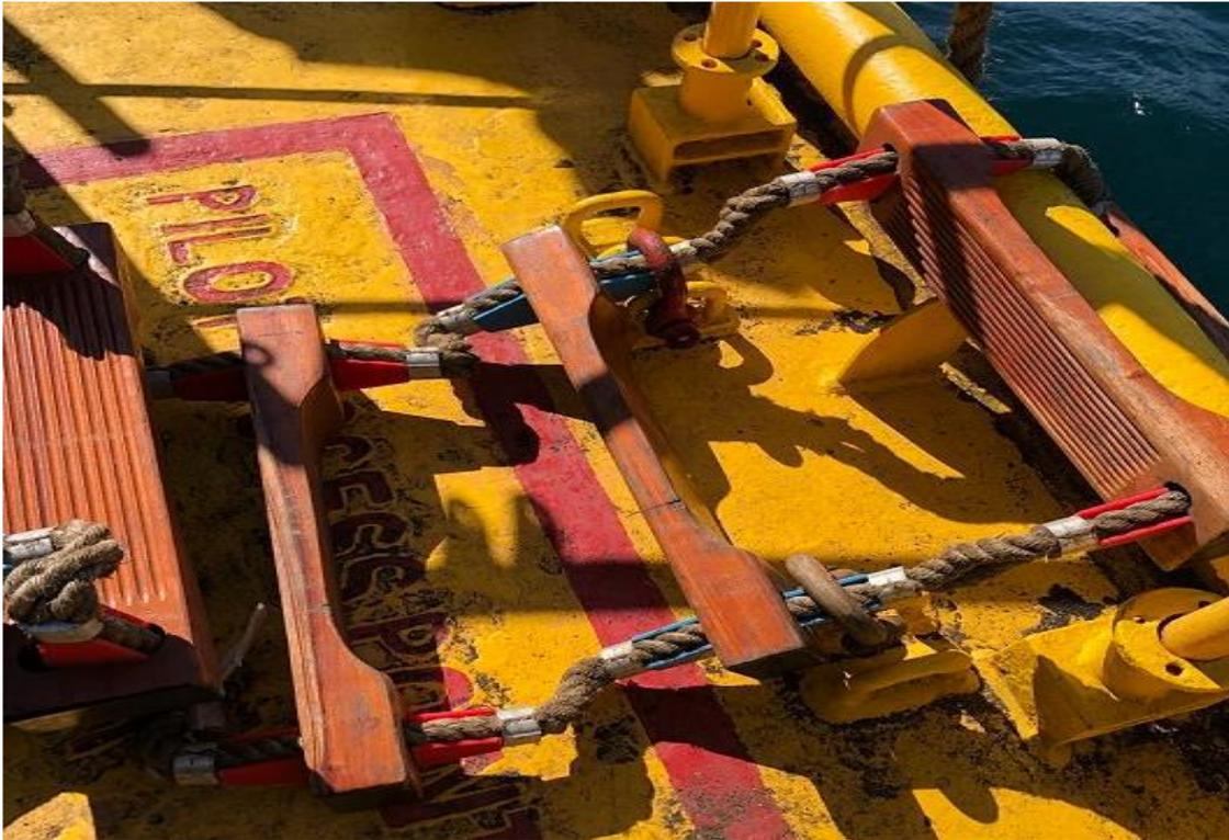
图片 4：不安全的引水梯固定装置（图片使用权获得了弗里曼托尔港务局许可）。
