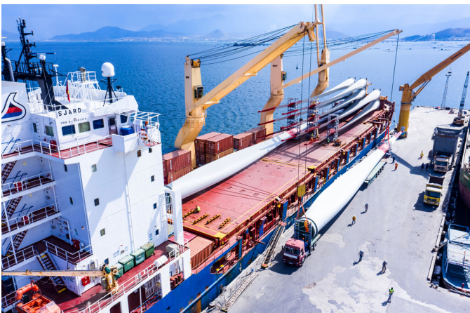
进行串联举升风机叶片的起重机
