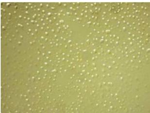
コーティングの膨れ(破裂前)
